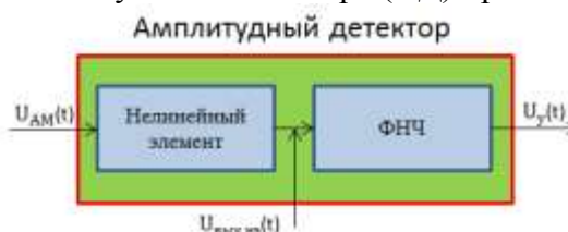
Рис. 3. Схема амплитудного детектора, где НЭ – нелинейный элемент (диод), ФНЧ – фильтр низких частот (R, C - цепь).
