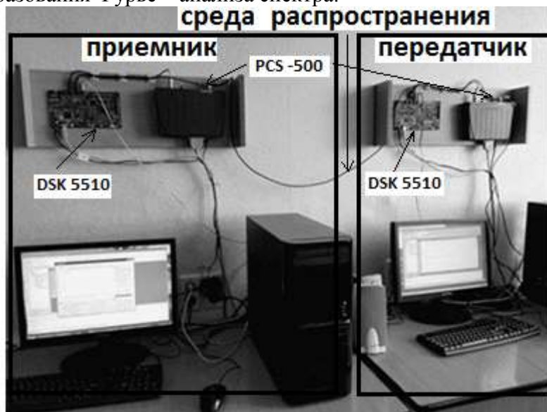
Рис.1. Лабораторная установка по исследованию приемо-передающих устройств на базе цифрового сигнального процессора TMS320C5510.
