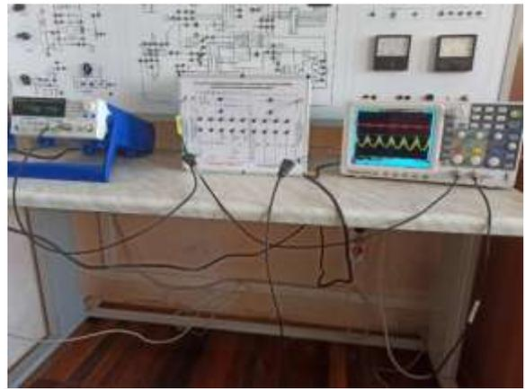
Рисунок 4 - Лабораторная установка по исследованию параметров сигналов в АД. Осциллограммы входного (верхняя) и выходного (нижняя) сигналов приведены на рисунке 5.
