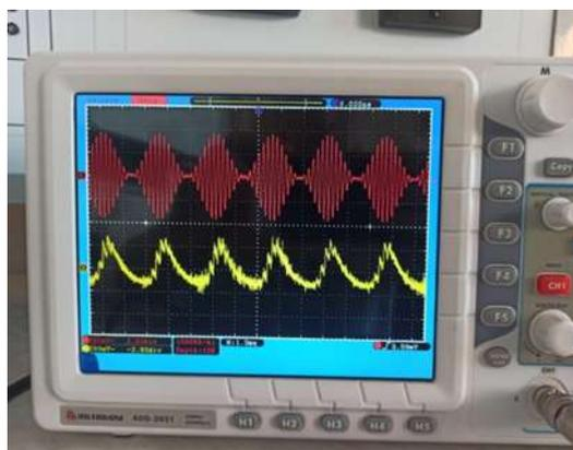
Рисунок 5 – Осциллограммы входного и выходного сигналов
