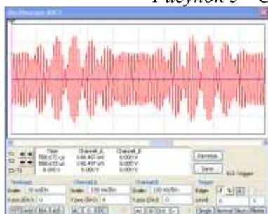
Рисунок 6 - Осциллограмма на входе смесителя
