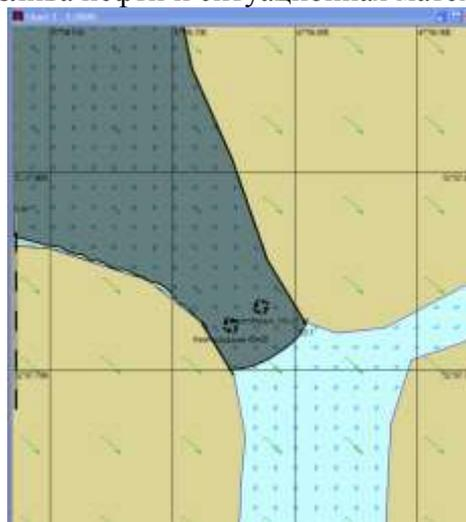
Рисунок 2 – Вариант защиты с применением бонов и нефтесборщиков
