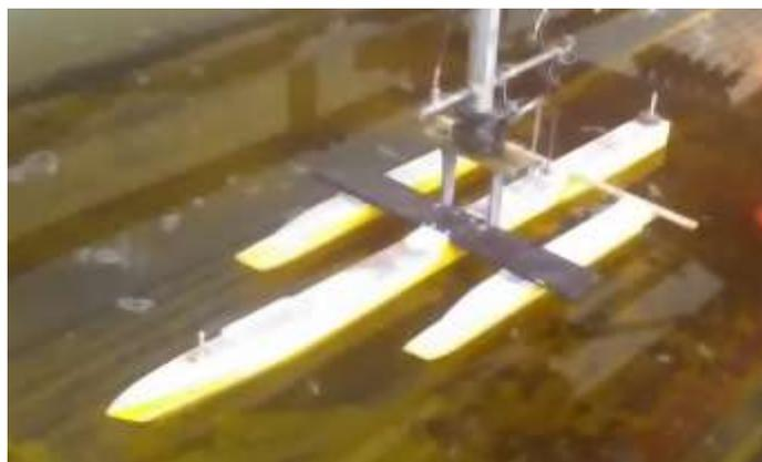
Рисунок 1 – Модель тримарана на испытаниях с центральным расположением аутригеров
