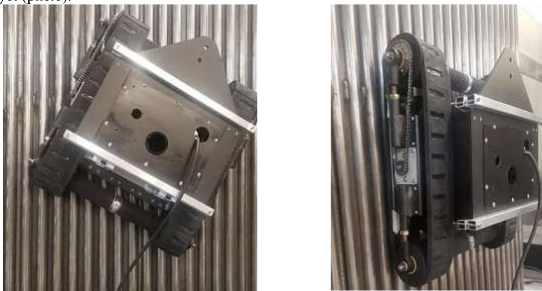
Рисунок 5 – Робот-альпинист для котельных труб
