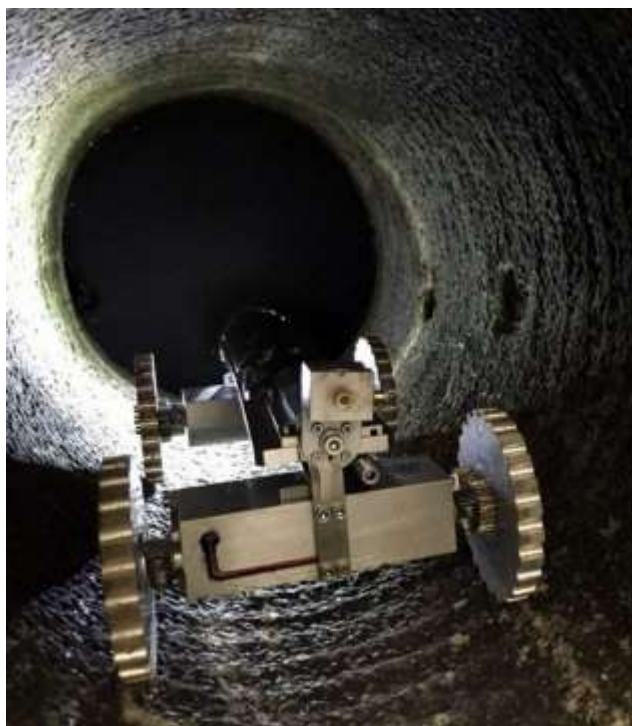
Рисунок 6 – Робот для инспекции трубопроводов
