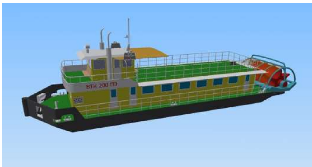
Рис.1. Проектное предложение Толкач БТК-200 ПЭ. Корпус и надстройка выполнены из конструкционного полиэтилена
