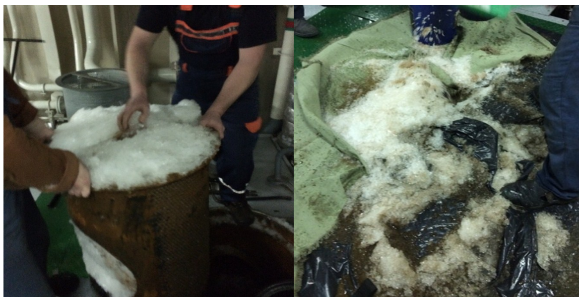
Рисунок 1 - Ручная очистка кингстонных ящиков и применение ловушек на судне «Сталинград»
