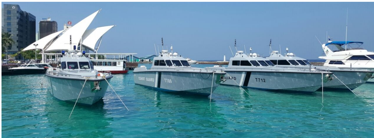
Рисунок 1 – Серия 16-метровых высокоскоростных катеров из КМ для береговой охраны Республики Мальдивы (проект автора)
