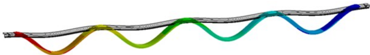
Рисунок 2 – Деформация балки после приложения осевых сжимающих напряжений и поперечной нагрузки
