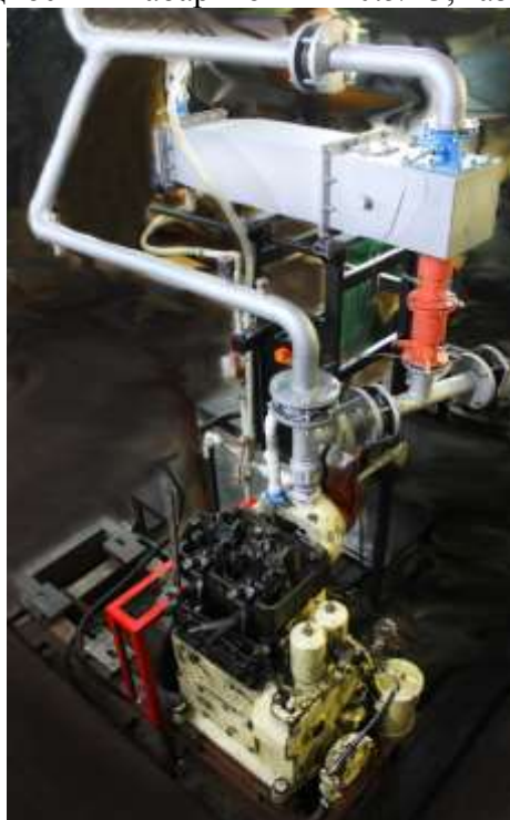
Рисунок 3 – Экспериментальный стенд на базе двигателя 2Ч 10.5/13
