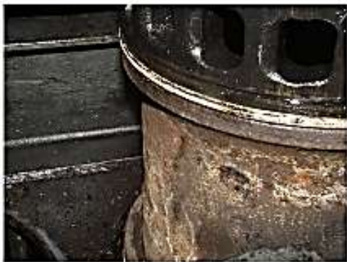
Рисунок 7 – Состояние втулок цилиндров до и через год после ЭМВ
