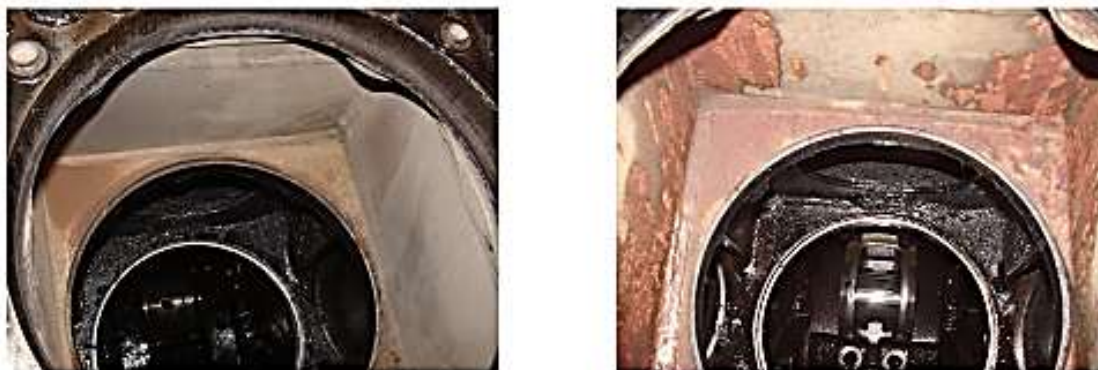
Рисунок 9 – Состояние рубашек охлаждения до и через год после обработки
