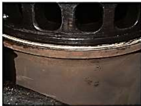
Рисунок 7 – Состояние втулок цилиндров до и через год после ЭМВ
