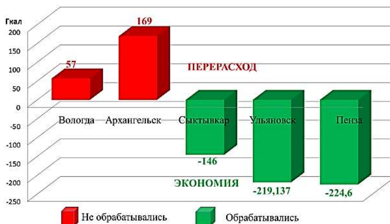
Рисунок 12 – Фактический перерасход/экономию теплоты на ремонтных предприятиях транспортного комплекса без и с применением ЭМВ
