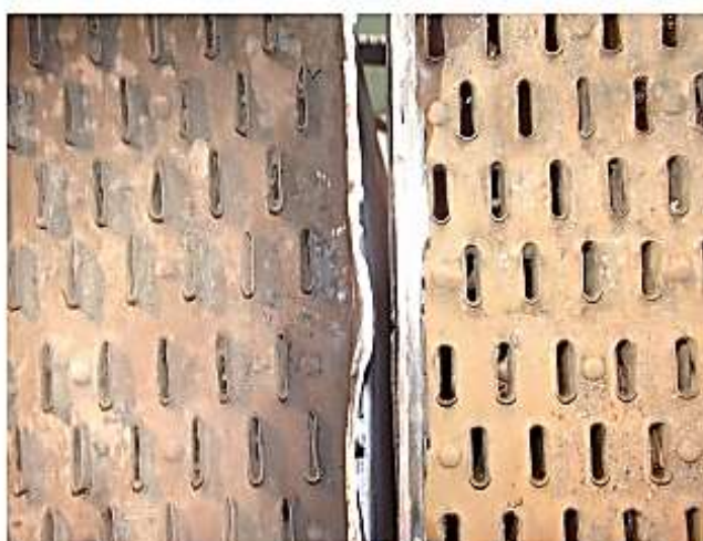
Рисунок 10 – Состояние секций холодильника до и через год после ЭМВ
