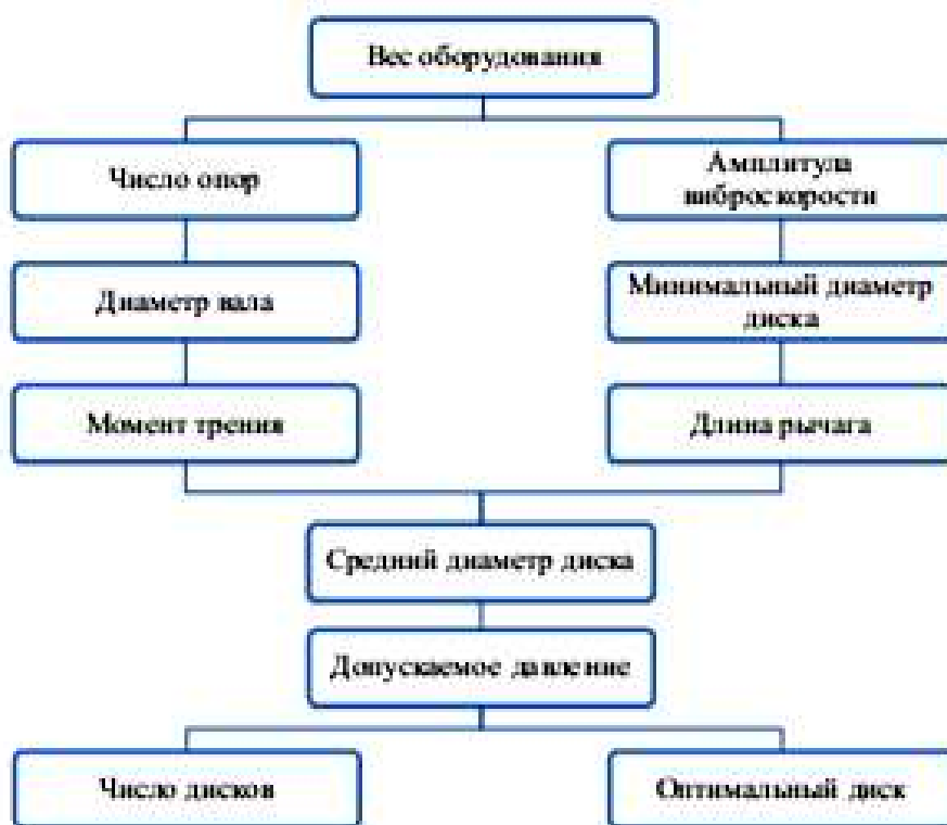
Рисунок 3 - Алгоритм проектирования компенсатора веса
