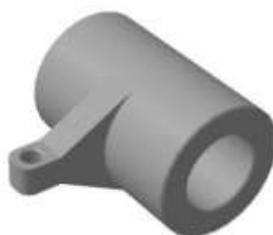
Рисунок 2 – Неподвижная полумуфта компенсатора веса с рычагом
