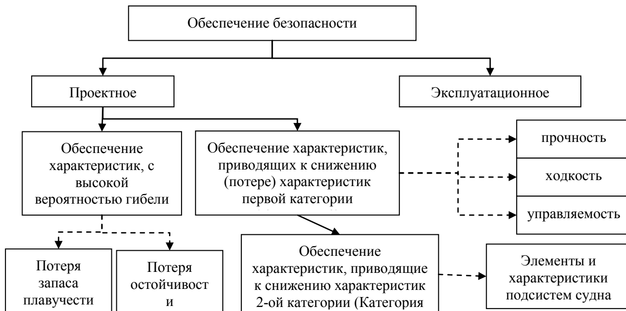
Рисунок 2 – Схема обеспечения проектной безопасности судна
