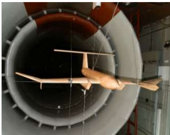
Рисунок 1 – Модель экраноплана с составным крылом в аэродинамической трубе.
