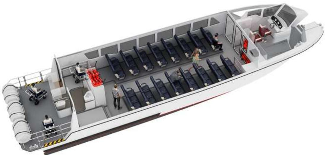
Рисунок 3 – Общий вид компоновки помещений пассажирского судна AMD1990
