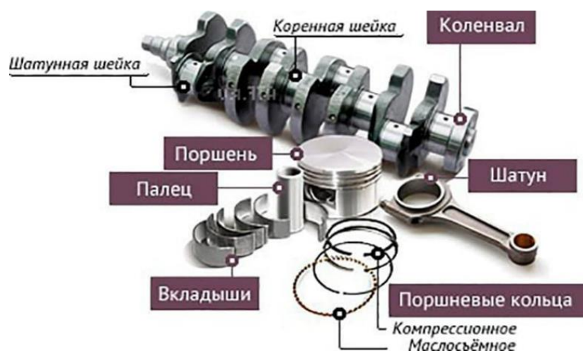
Рисунок 9 – Некоторые подвижные детали судового двигателя
