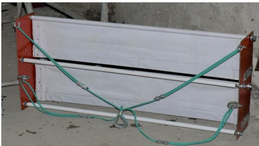
Рисунок 8 – Модель гидропарусного гидродинамического якоря с продольными латами с аэродинамическим наполнением гидропарусов
