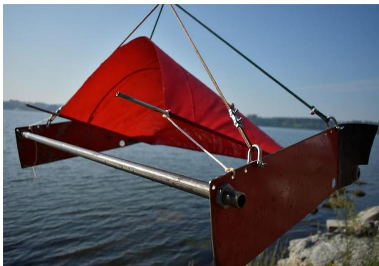
Рисунок 7 – Гидродинамический якорь с гидропарусом
