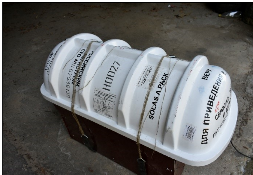
Рисунок 6 – Контейнер спасательного плота, разработанного ФГБОУ ВО «СГУВТ»
