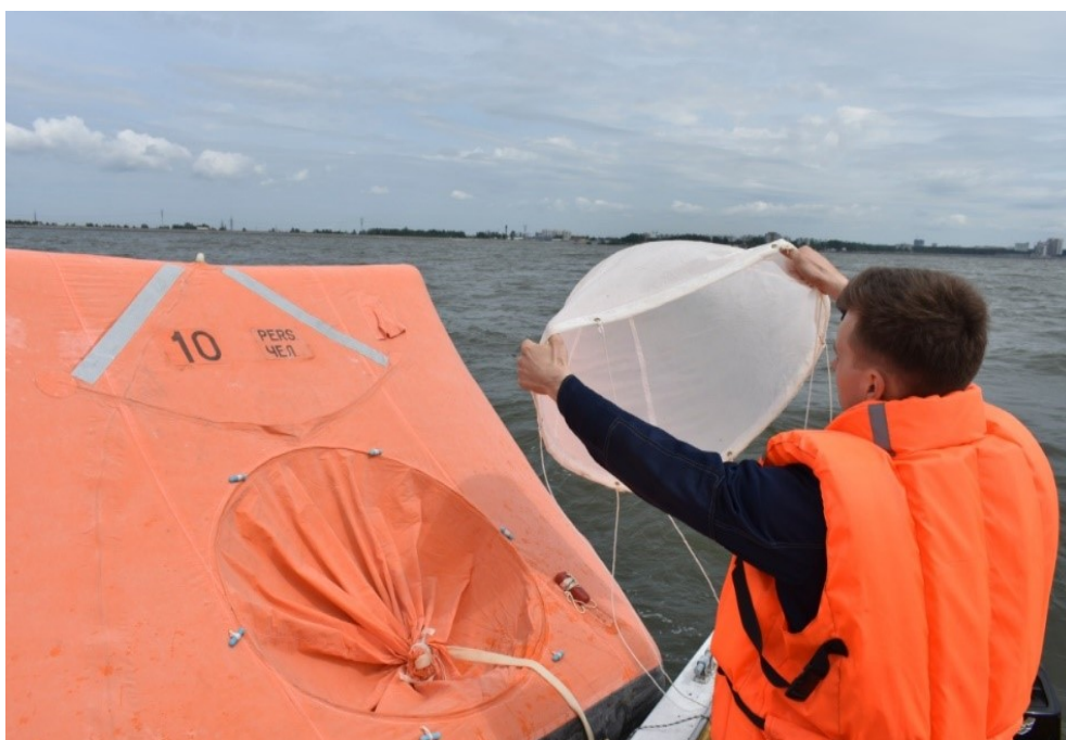
Рисунок 4 – Спасательный плот со штатным плавучим якорем
