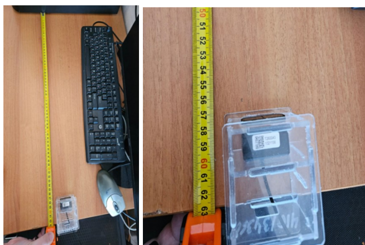
Рисунок 3 – Фото проверки результатов измерений расстояния до препятствия лидаром
