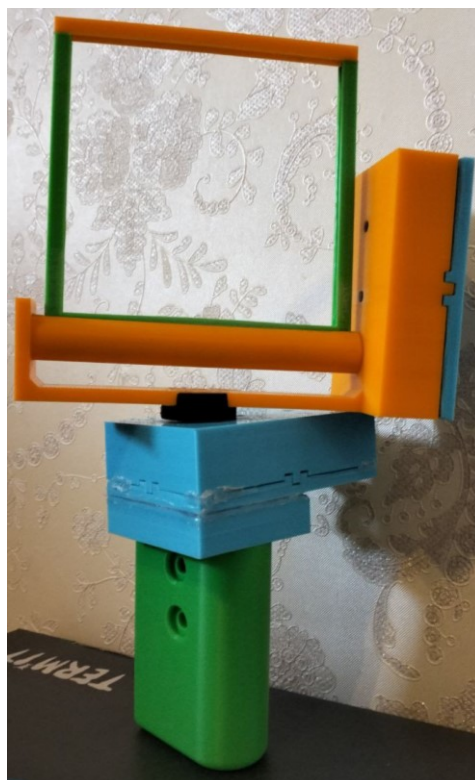
Рисунок 2 – Однозеркальный секстан №2, редукторное отсчётно-стопорное устройство
