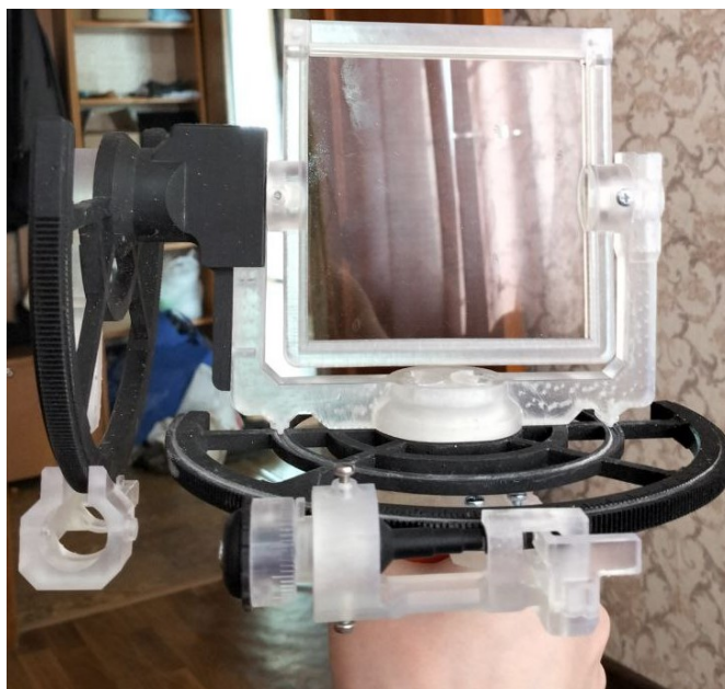
Рисунок 3 – Однозеркальный секстан №3, червячно-лимбовое отсчётно-стопорное устройство
