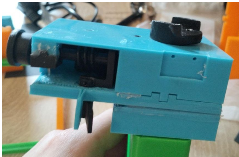
Рисунок 1 – Редукторное отсчётно-стопорное устройство для однозеркального секстана
