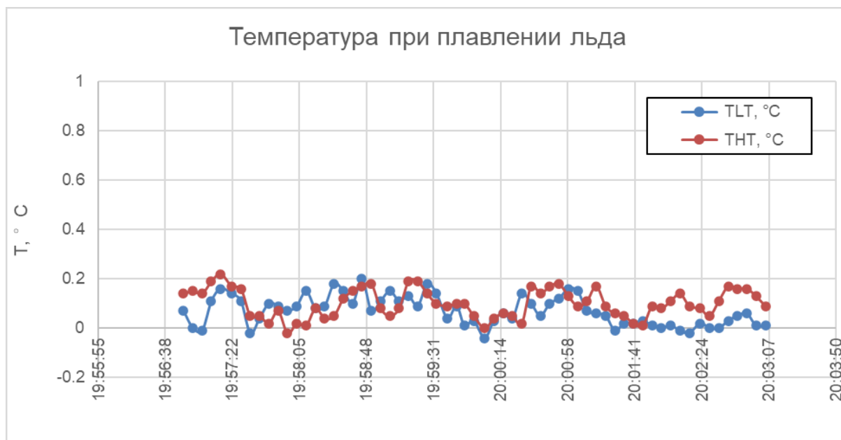
Рисунок 5 – Показания термопар при плавлении льда с учетом калибровочной зависимости
