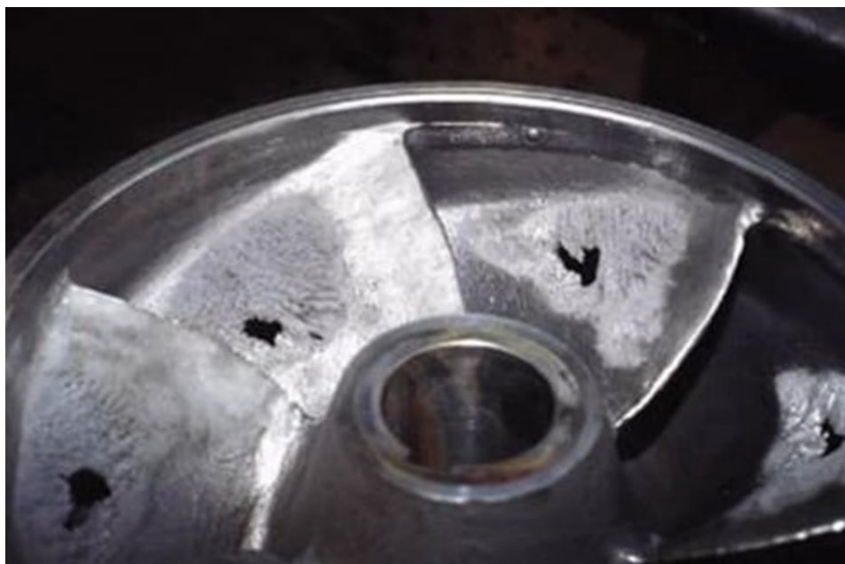
Рисунок 2 – Кавитационное разрушение крыльчатки насоса
