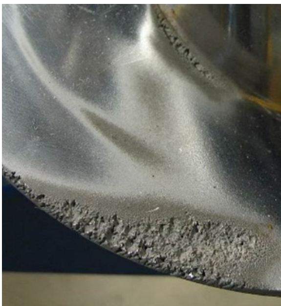
Рисунок 1 – Эрозионное разрушение поверхности гребного винта
