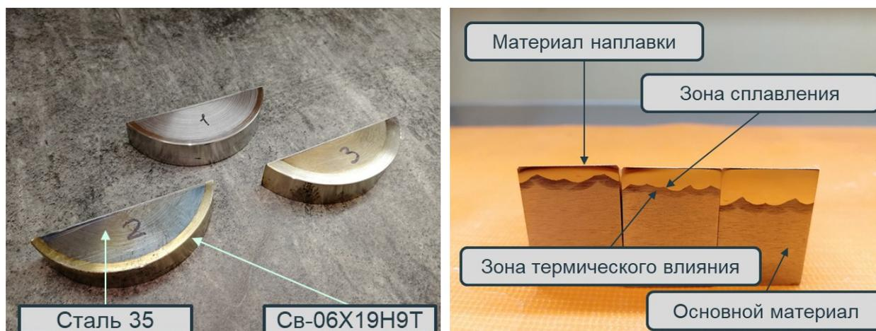
Рисунок 2 – Образцы многослойной наплавки
