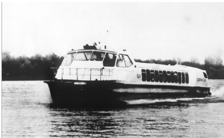
Рисунок 2 – СВП скегового типа «Орион»
