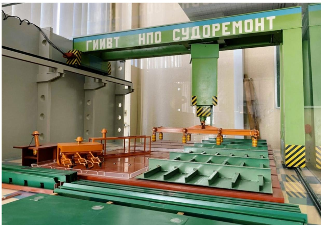
Рисунок 1 – Универсальная краноманипуляторная установка СММ-100
