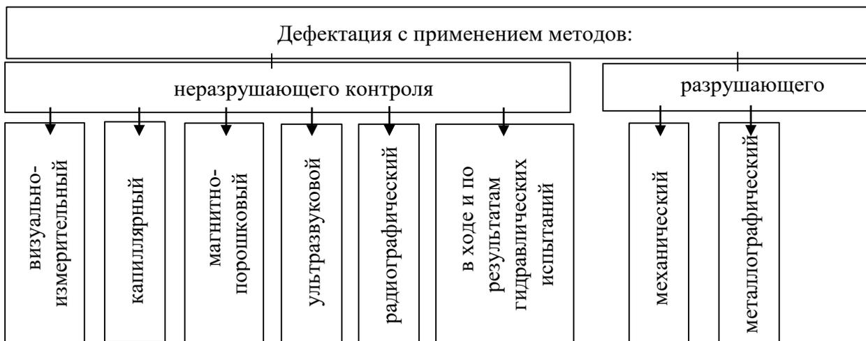
Рисунок 2 – Способы проведения дефектации
