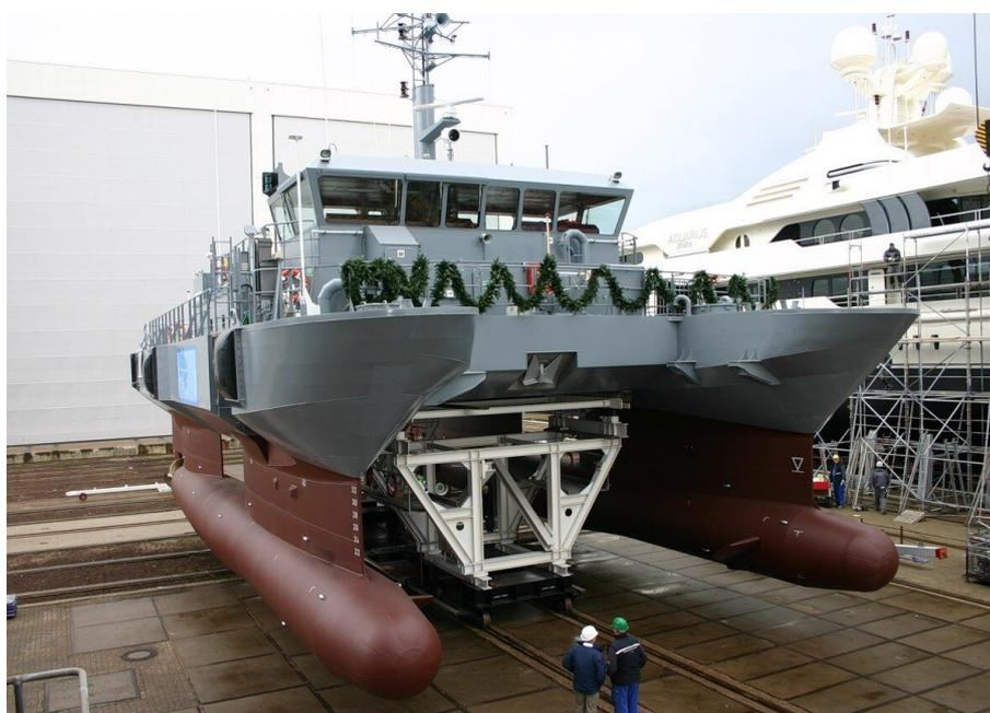
Рисунок 7 – Судно с малой площадью ватерлинии [7]
