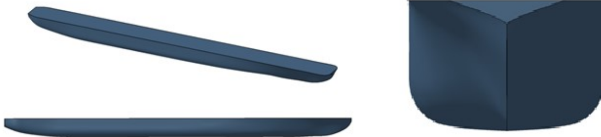
Рисунок 2 – Твердотельная геометрия корпуса большегрузного катамарана
