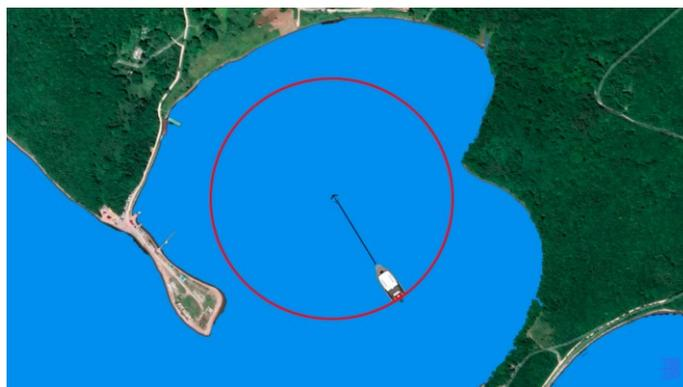
Рисунок 2 – Вращение судна вокруг точки зацепления веретена за грунт
