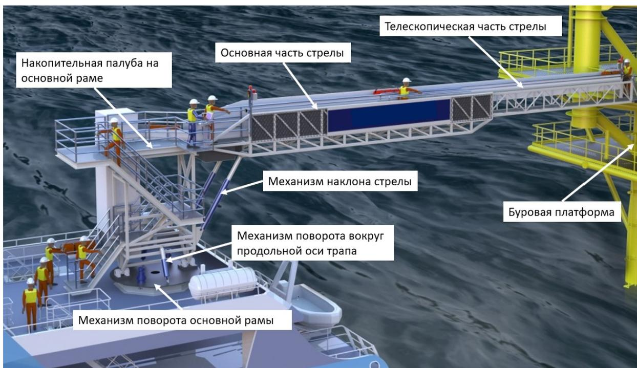
Рисунок 1 – Телескопический трап в штатном режиме работы
