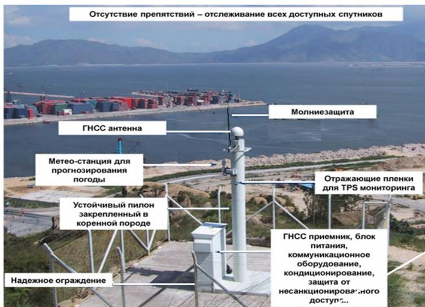
Рисунок 2 – Постоянно действующая дифференциальная станция [6]
