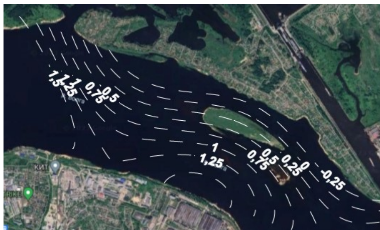
Рисунок 5 – Верификация расчетных параметров профиля поверхности воды
