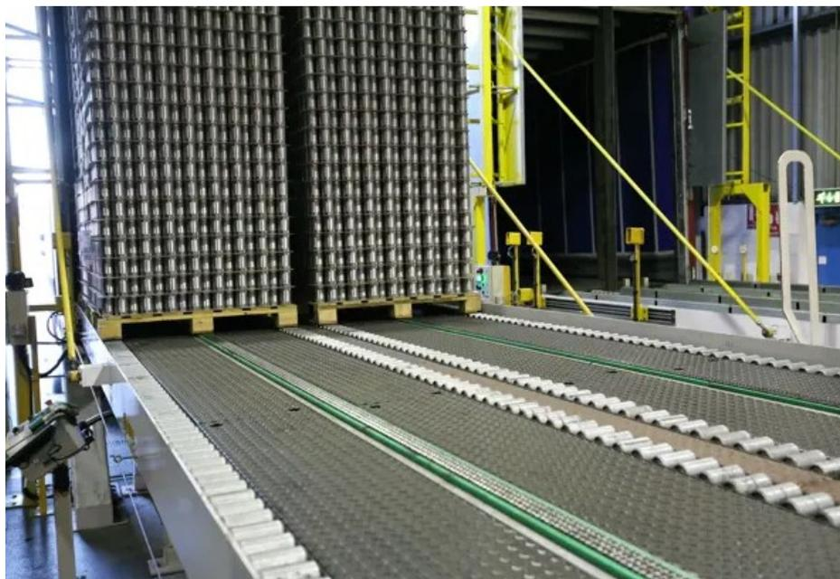
Рисунок 2 – Конвейерная система движущегося пола «Joloda Hydraroll»
