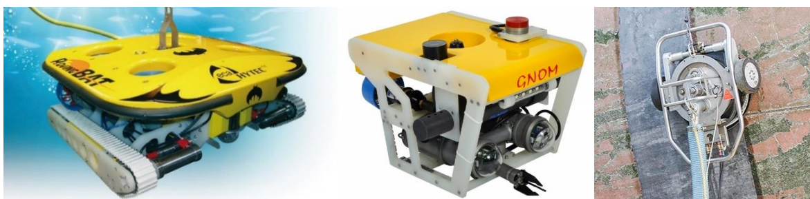
Рисунок 2 – Телеуправляемые роботы для работы с корпусом судна [2, 3]
