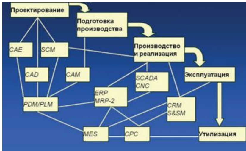
Рисунок 2 – Стадии жизненного цикла изделий судостроительной промышленности и системы их автоматизации в концепции PLCS -технологий
