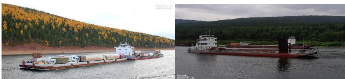
Рисунок 1 – Судно типа СК-2000 для перевозок накатных грузов
