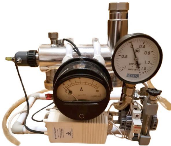
Рисунок 1 – Экспериментальный стенд по определению мощности бактерицидного УФ-излучения коронного разряда в водной среде
