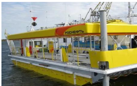
Рисунок 1 – Плавающая заправочная станция ПЗС МС-001
