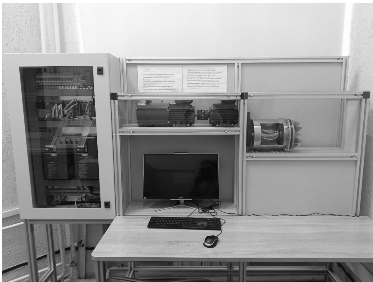
Рисунок 2 – Стенд имитации работы валовой линии
