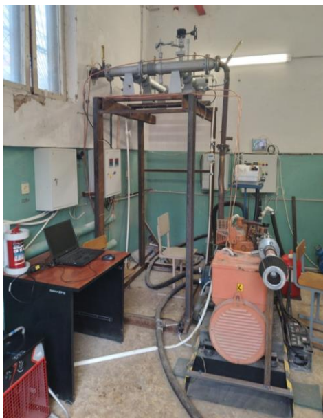
Рисунок 1 – Стенд на базе конвертированного двигателя Ivesco 8041i06
