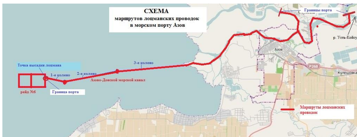
Рисунок 2 – Схема маршрутов лоцманских проводок в морском порту Азов
