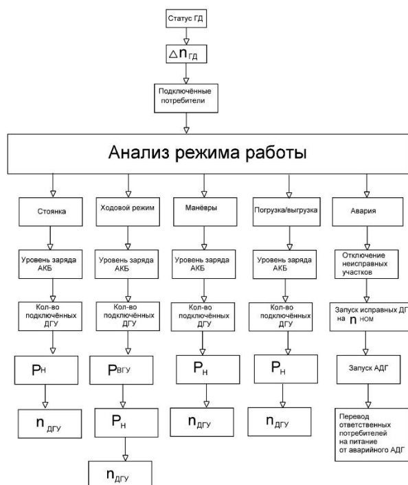
Рисунок 1 – Блок-схема системы управления электроснабжением судна
