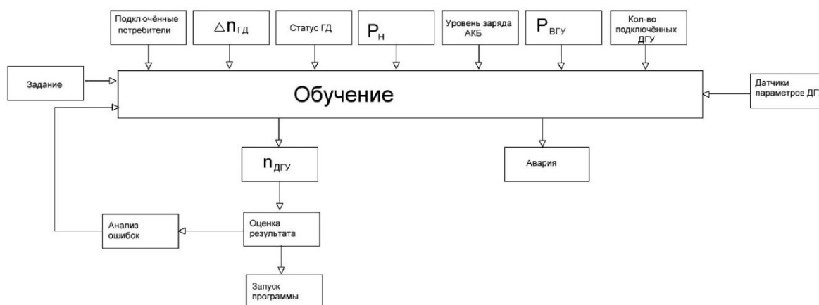
Рисунок 2 – Блок-схема системы управления электроснабжением судна построенная на базе МО
