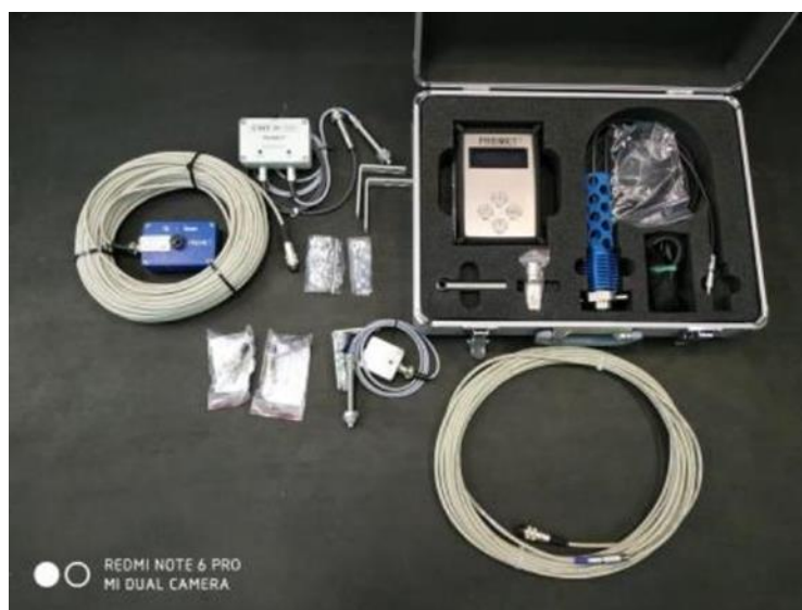
Рисунок 3 – Внешний вид индикатора «PREMET M» (CMT)
