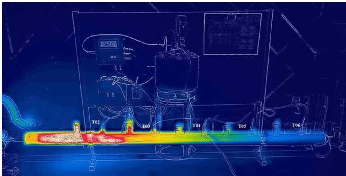
Рисунок 3 - Распределение температуры по длине газохода данным тепловизионной съемки
