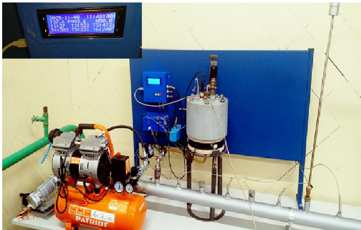
Рисунок 2 – Модуль БРИЗ в составе экспериментального стенда термического обезвреживания нефтесодержащих вод
