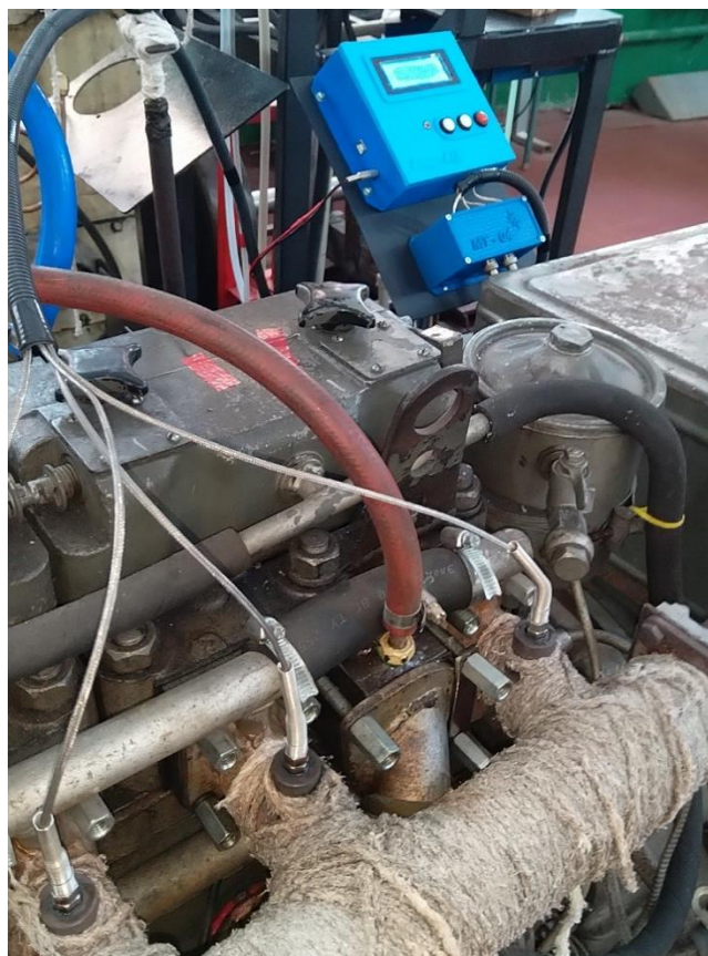
Рисунок 3 – Модуль БРИЗ при измерении температуры отработавших газов двигателя 4 Ч 8,5/11
