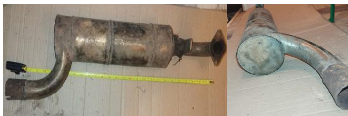
Рисунок 2 – Схема, сечения и фотография активного трехкамерного глушителя, предложенная Глубоковым Е.В., где: D_k – внутренний диаметр корпуса; L_{тр} – длина резонансных трубок
