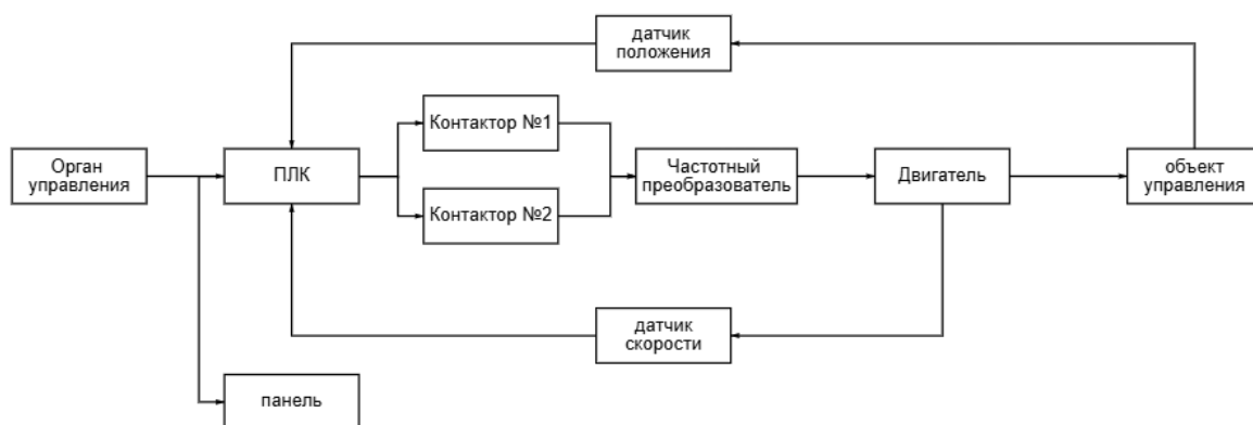
Рисунок 2 – Структурная схема системы управления башни крана
