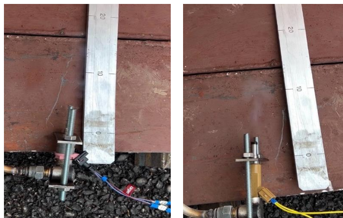
Рисунок 3 – Определение длины распыла аммиака (справа форсунка 1, слева форсунка 2)
